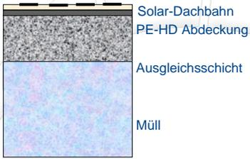
Das Diagramm zeigt den Aufbau der SolarDachbahn in vier Schichten: Solar-Dachbahn (oben), PE-HD Abdeckung, Ausgleichsschicht und Müll (unten).
