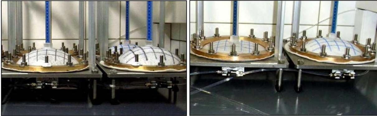
**Bild 6** Multiaxialer Kriechversuch 100 kPa (links) 20 kPa (rechts) nach Start.
