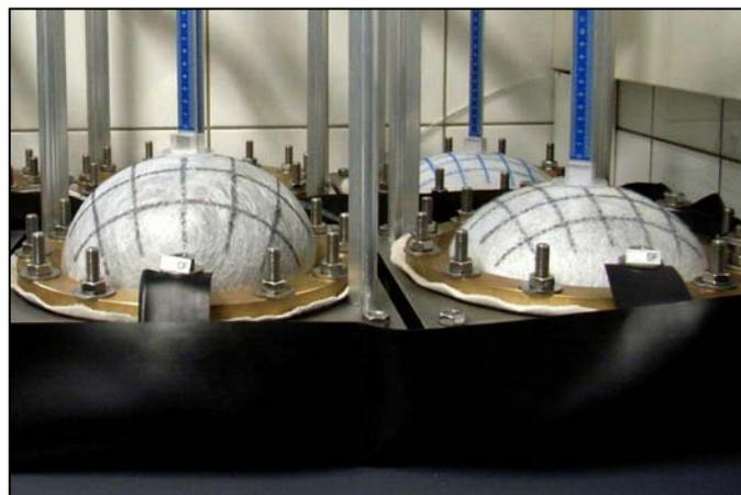
**Bild 8** Multiaxialer Kriechversuch 100 kPa nach 1500 Stunden.
