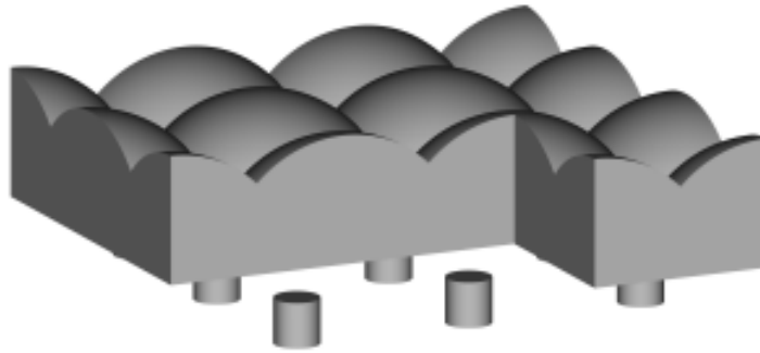
Bild 3: Räumliche Traggewölbe über den Pfahlelementen
