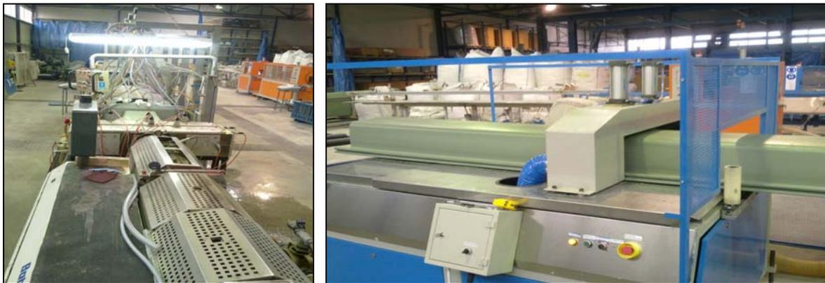
**Abbildung 1:** Herstellung von DuoLock Profilen im Extrusionsverfahren
