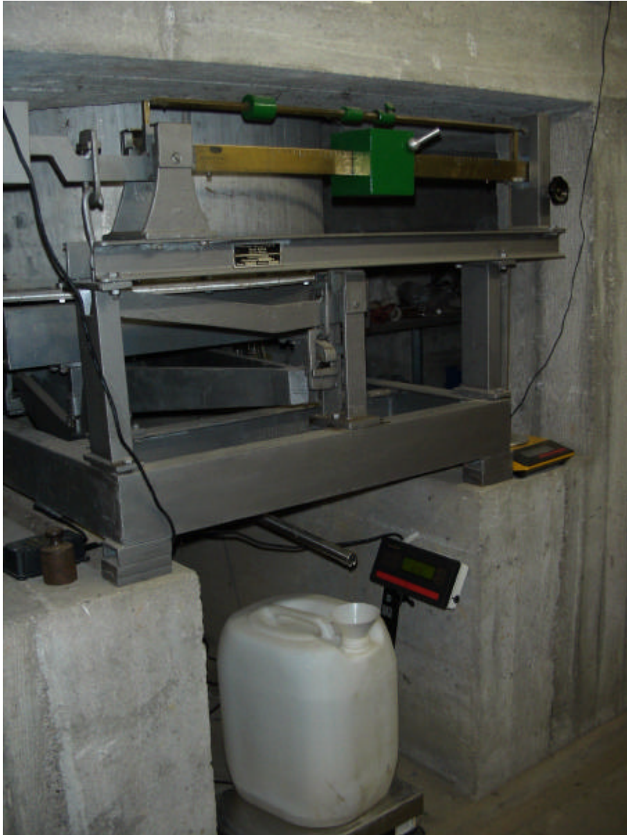
Abb. 2: Wägeeinrichtung eines Lysimeters
