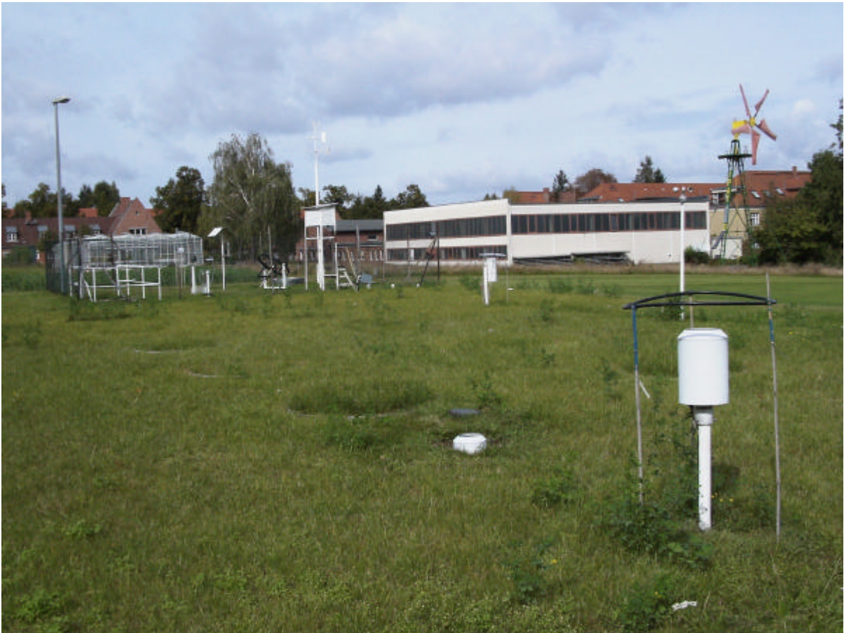
Abb. 1: Lysimeteranlage Berlin-Dahlem (Lysimeteroberfläche)
