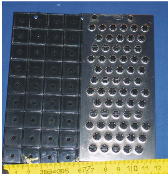
Bild 3: Auf den Keilen fest montierte Reibungspartner mit denen Bentonitmatten oder Kunststoff-Dränmatten in den Probehälter verbunden sind.
