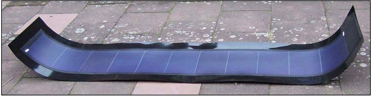
Abbildung 1: Flexibler Dünnschicht-Solarmodulstreifen im Verbund mit KDB
