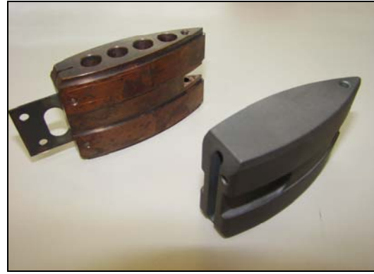
Bild 1: Eingebauter Heizkeil aus Keramik sowie Einzel-Keile aus Kupfer (seitliche Beheizung) und Keramik (Beheizung durch hintere Keramikplatte)
