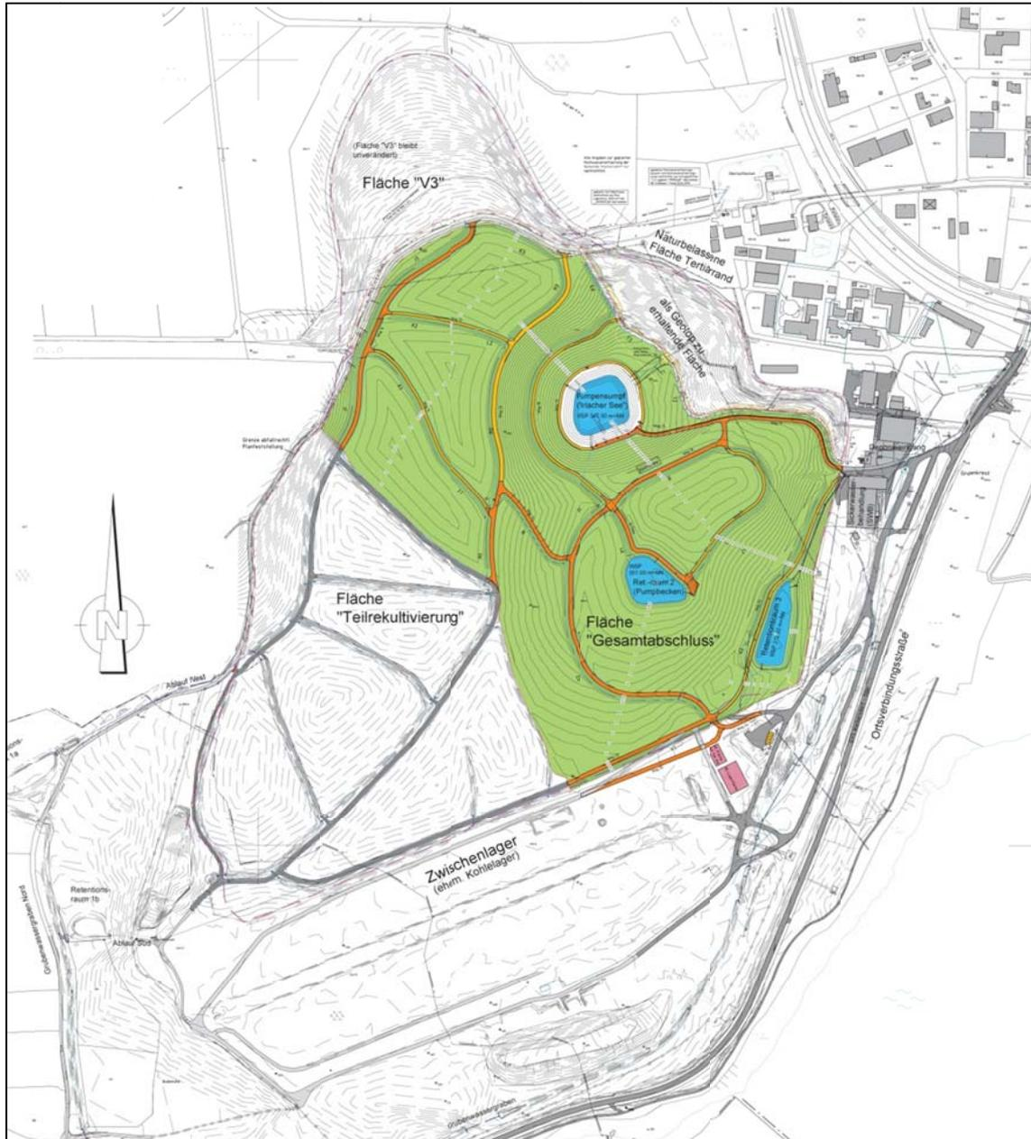
**Abb. 4:** Übersichtslageplan Planung Gesamtabschluss (© BASE TECHNOLOGIES)
