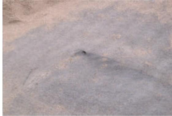
**Bild 6:** Deponie Niemark, 2. BA, geortete Beschädigung, 15mm x 10mm
