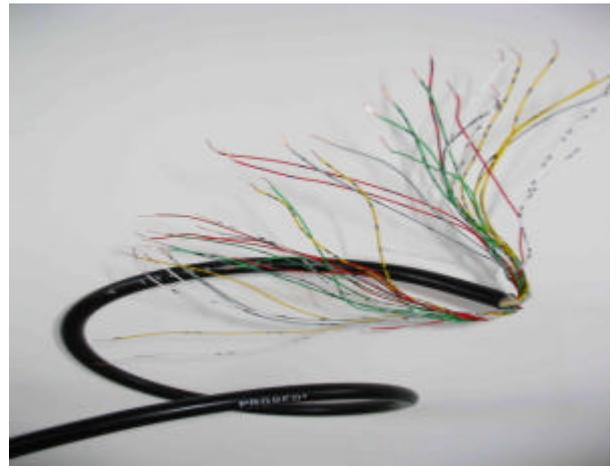
**Bilder 3 und 4:** beschädigtes Kabel – ein normgerechtes Kabelidentifikationssystem ermöglicht jederzeit die fehlerfreie Reparatur
