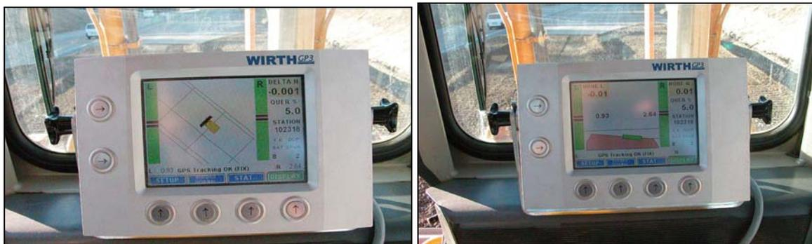
**Abb. 5** Vollautomatische Steuerung in der Fahrerkabine Quelle: Max Bögl
