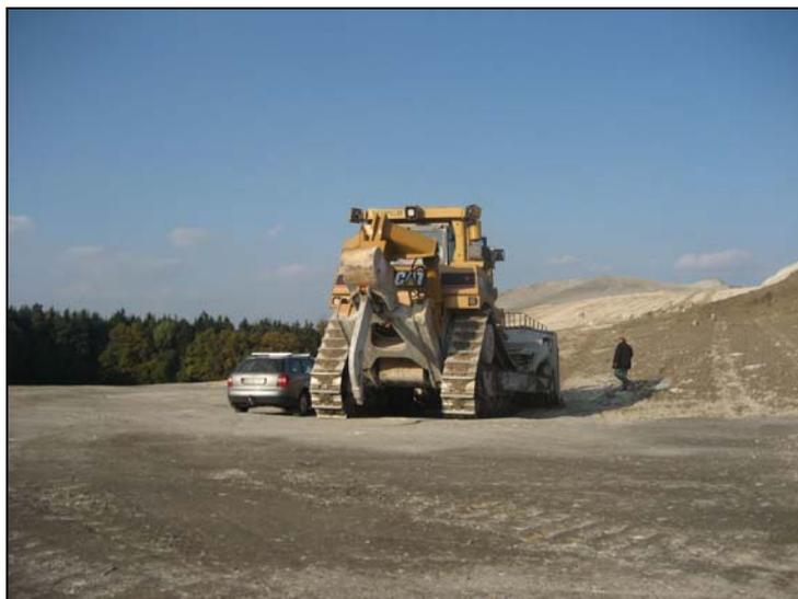
**Abb. 6** Schubraupe D 10 T im Größenvergleich Quelle: Baudienststelle Schlackenberg
