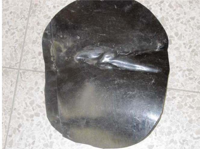
**Bild 6:** Praxisbeispiel IV einer „Einsparung“ durch die Verwendung einer PE-HD Kunststoffdichtungsbahn mit einer Dicke von  $d = 1,5$  mm
