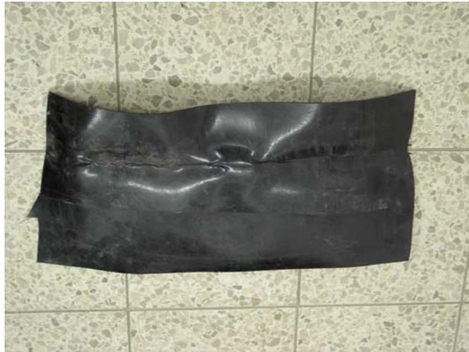
**Bild 4:** Praxisbeispiel II einer „Einsparung“ durch die Verwendung einer PE-HD Kunststoffdichtungsbahn mit einer Dicke  $d = 1,5$  mm
