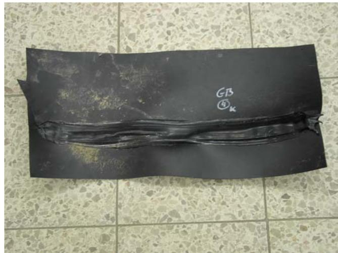
**Bild 3:** Praxisbeispiel I einer „Einsparung“ durch die Verwendung einer PE-HD Kunststoffdichtungsbahn mit einer Dicke  $d = 1,5$  mm
