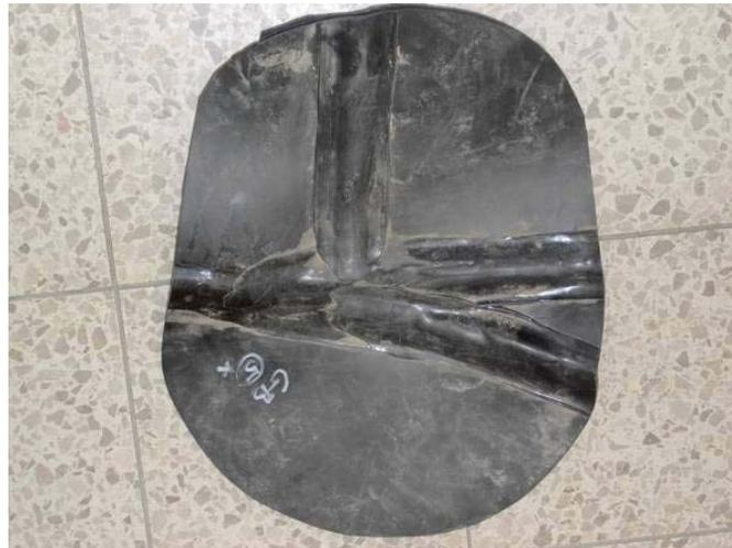
**Bild 5:** Praxisbeispiel III einer „Einsparung“ durch die Verwendung einer PE-HD Kunststoffdichtungsbahn mit einer Dicke  $d = 1,5$  mm
