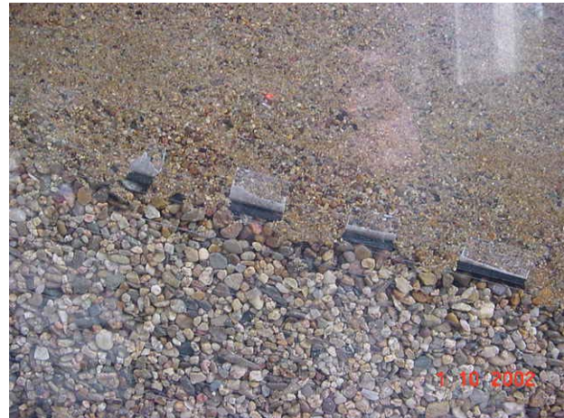
Bild 3.2: Dichtungsbahnstreifen in der Grenzfläche
