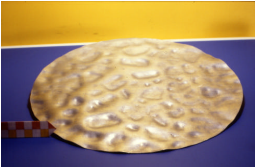
Bild 7: Deformiertes Weichblech nach einem Druckversuch
