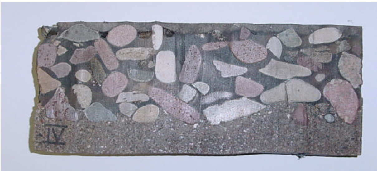
Bild 11: Schutzschicht aus Sand, Dicke ca. 2 cm, Kies 16/32, Belastung 1 \text{ MN/m}^2
