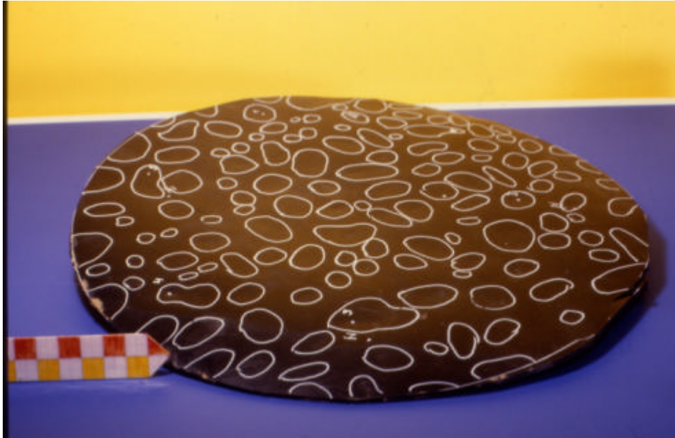
Bild 5: Nach Ausbau aus einem Belastungsversuch markierte Dichtungsbahn
