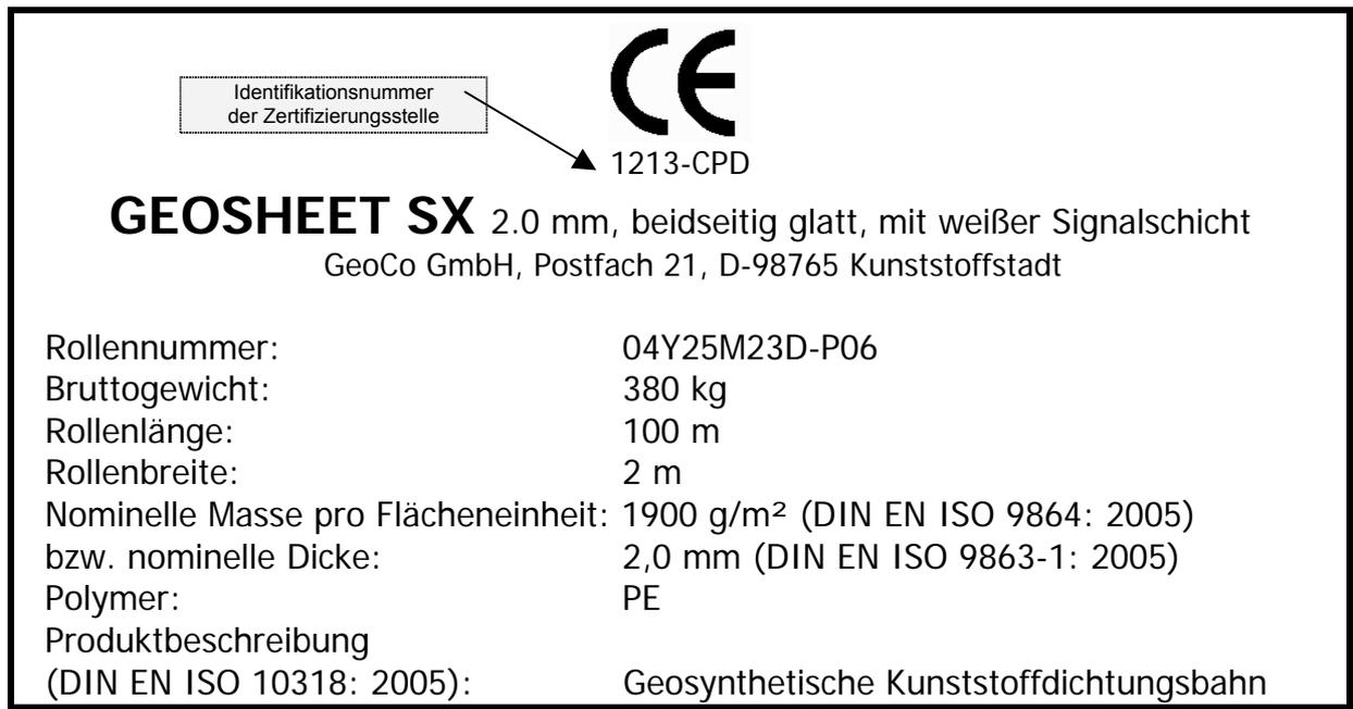
**Bild 4:** Beispiel eines Rollenetiketts nach DIN EN ISO 10320 für eine GTD
