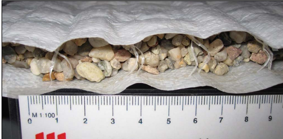
Bild 3: Kapillarblockbahn der Fa. G quadrat, seitlich geöffnet (im Vordergrund die Abstandsäden des Gewebes freigelegt)
