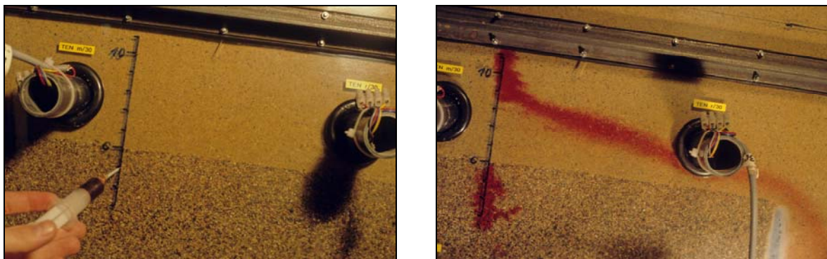
Bild 1: Farbtracerversuch in einer Kippbinne: Injektion des Farbtracers in Kapillarschicht und Kapillarblock entlang einer senkrechten Linie (links) und laterale Verlagerung des Farbtracers mit dem Wasserfluss nach 60 min (rechts)
