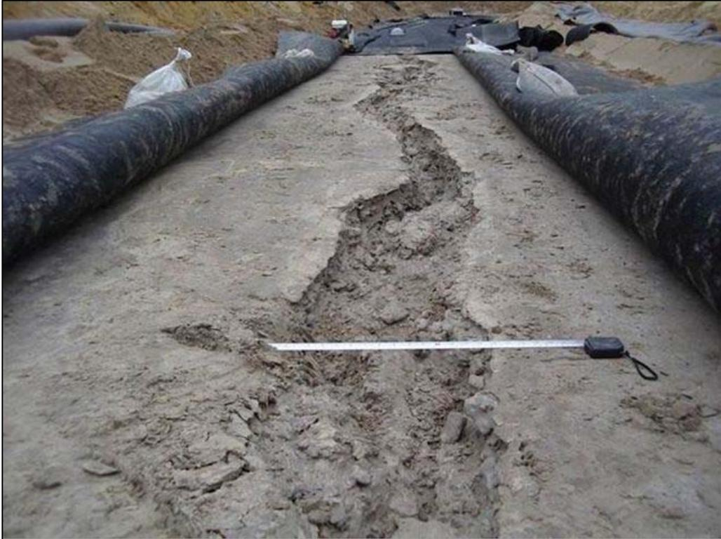
**Abbildung 10:** Verdeckter Schaden, unterspulte KDB
