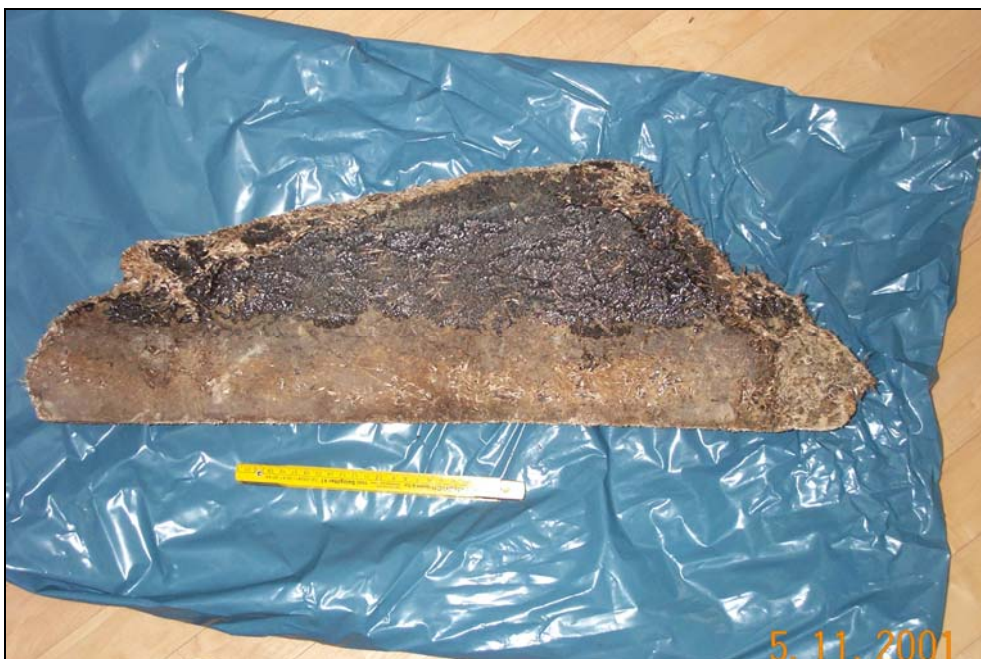
Bilder 3a/b: Ausgebauter GfK Schacht mit Auflösungserscheinungen / Wanddetail
