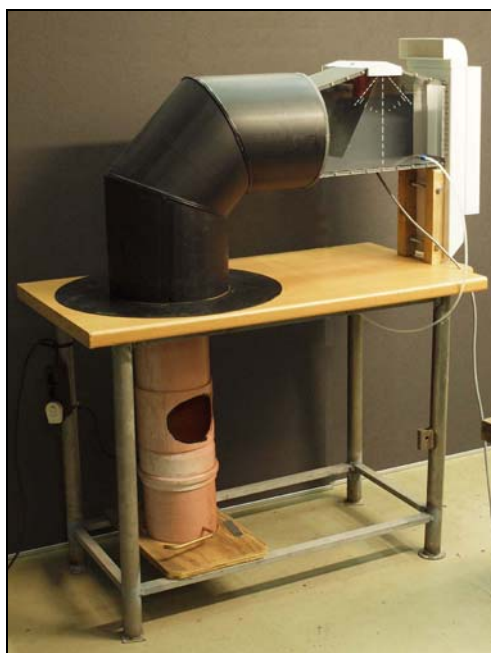
Bild 14: Richtungsmesskammer auf dem Niederdruck-Luftprüftisch (einatmend)
