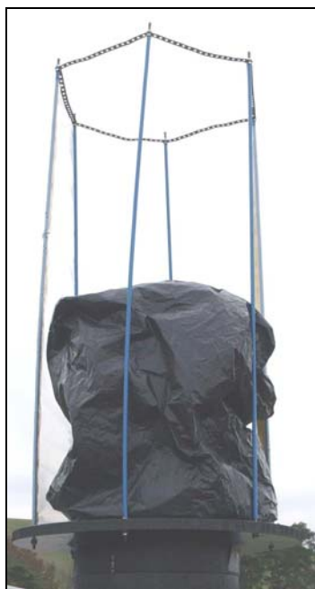
Bild 4: Foliensack-Volumeter 120 Liter, für Auslaßstutzen mit Durchmesser 315 mm, während die Stoppuhr läuft
