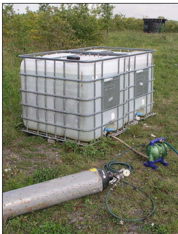
Bild 11: Druckluftpumpe an Wassertank
