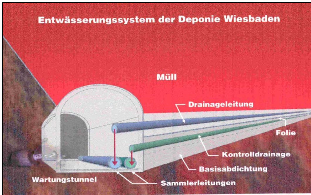
Bild 3: Beispiel eines Deponieentwässerungssystems
