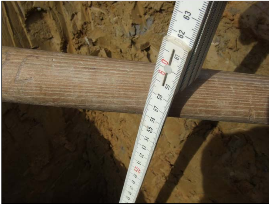
Abb. 14: Schichtdickenbestimmung in der mineralischen Dichtung
