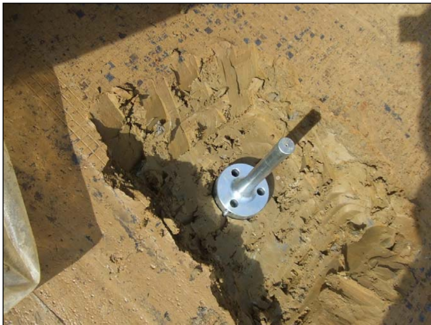
Abb. 13: Entnahme einer Sonderprobe
