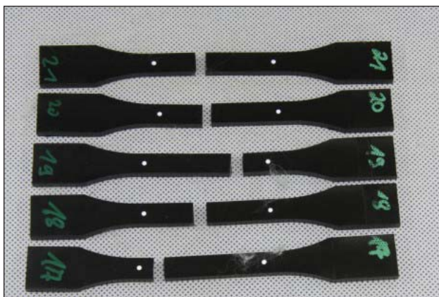
Gealterte Zugstäbe mit sprödem Versagen
