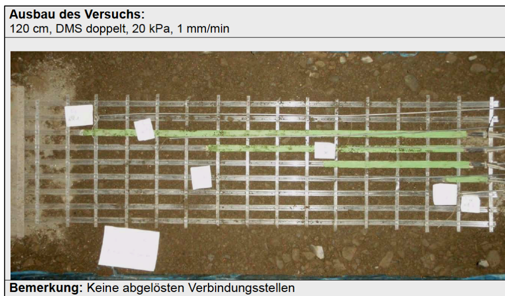
Abb. 14: Visuelle Bewertung von Geogitterproben unter Gebrauchslasten nach Ausbau aus einem Herausziehversuch (Auflast 20 kPa, TU Clausthal, 10/2010), exempl. für Secugrid® 200/40 R6
